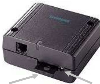
Bild 1. GSM modem med lucka och knapp
