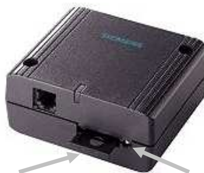
Fig 1. Modem GSM avec couvercle et bouton.
